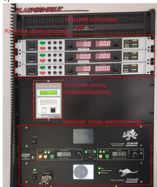
Rysunek 4. a) Naparowywarka. b) Panel główny naparowywarki. W czerwonych ramkach zaznaczone zostały najważniejsze komponenty.
